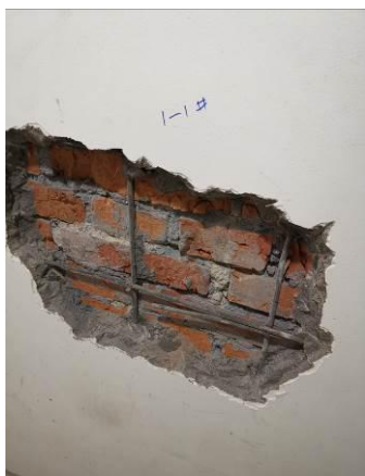
附照 23 墙面开凿检测砌体材料强度
